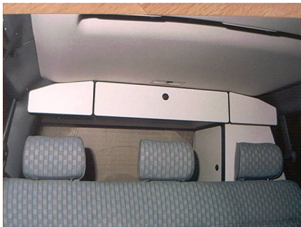
Beispiel Dachstaukasten mit Klimahimmel
